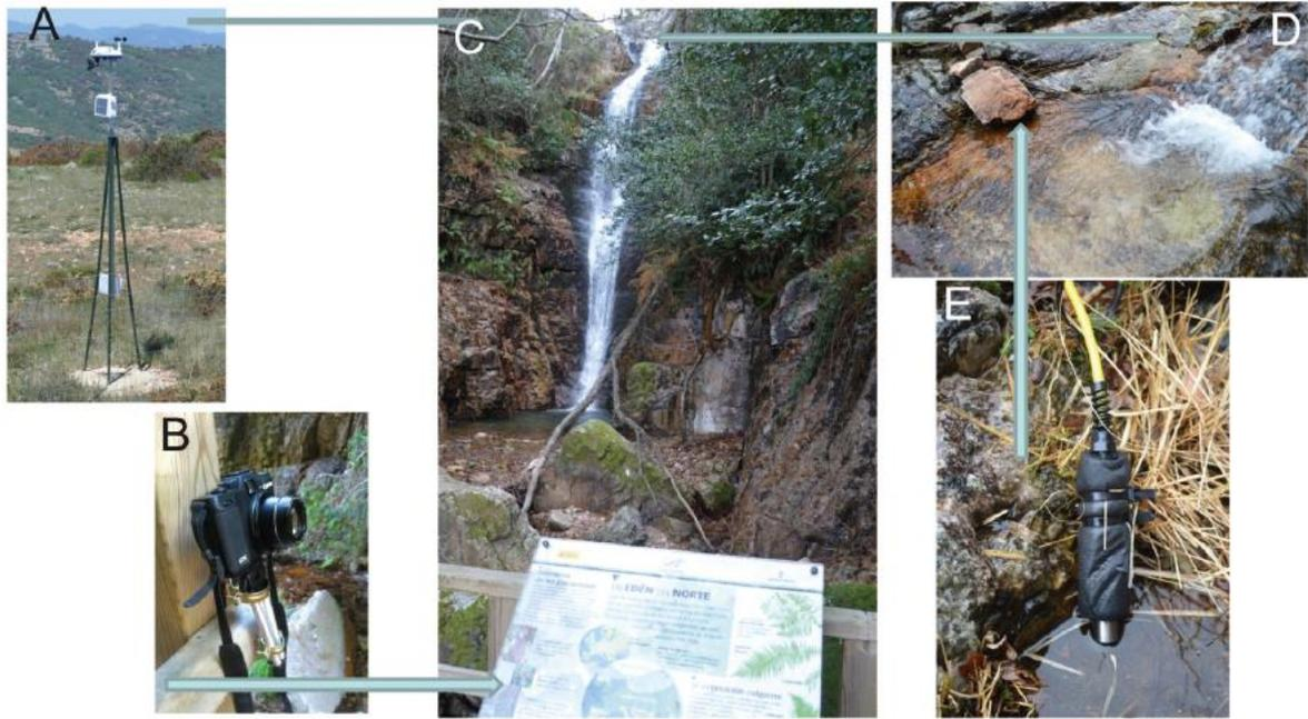
Figura 16 – Instrumentos instalados para o monitoramento das condições hidrológicas da cascata El Chorro de Los Navalucillos, Espanha: A) estação metereológica; B) câmera fotográfica; C) painel informativo; D) parte alta da cachoeira onde foi instalado o limnómetro piezoresistivo (E).
