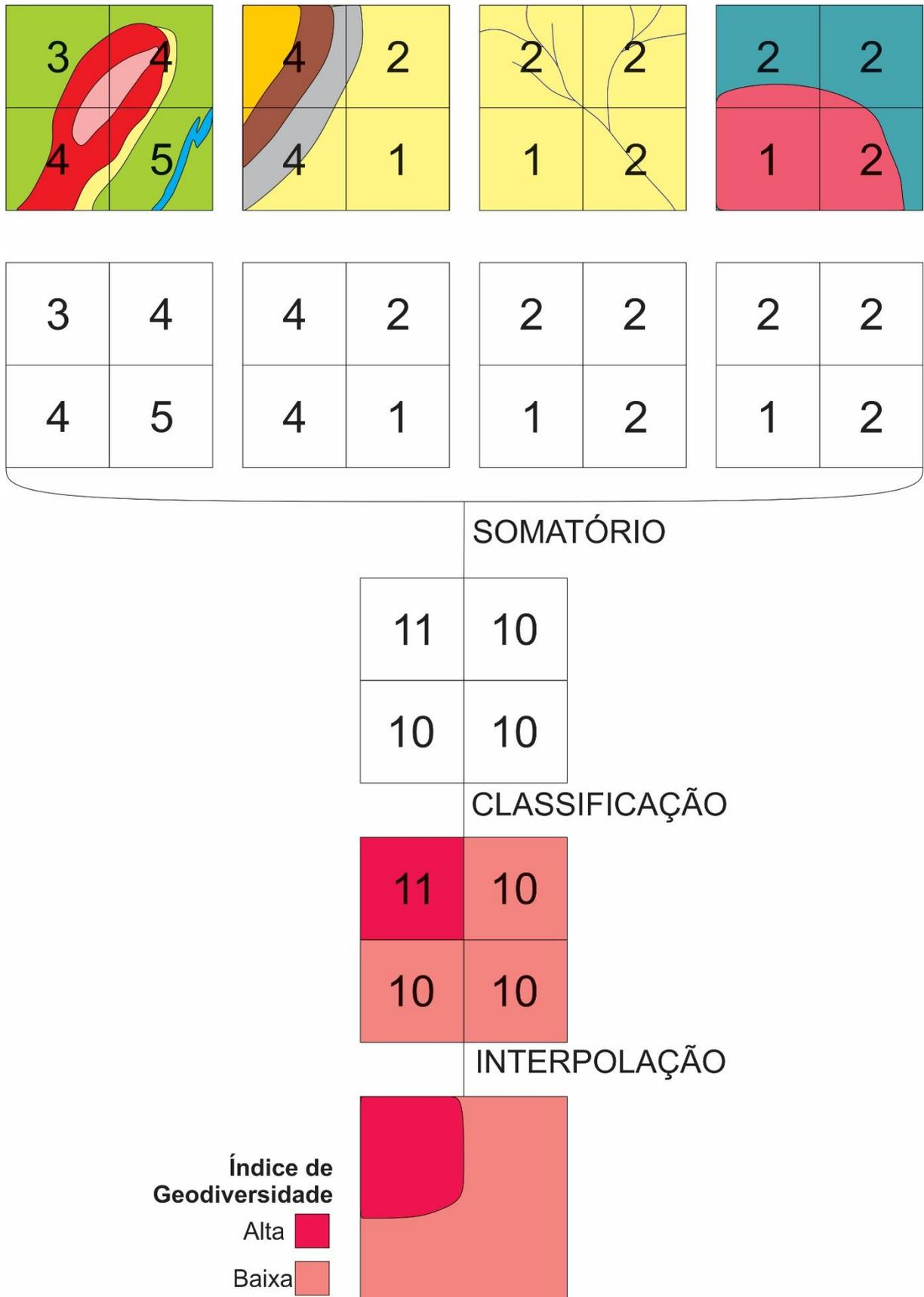
Figura 28 – Representação simplificada do método de análise quantitativa da geodiversidade proposto por Pereira *et al.* (2013).
